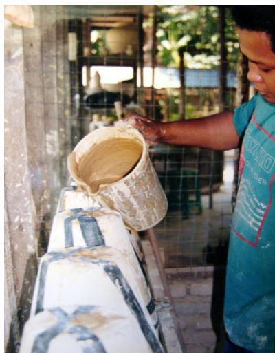
Gambar 16. Slip dituang ke dalam acuan plaster of Paris .
