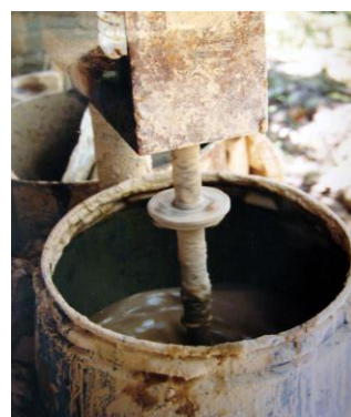
Gambar 7. Mesin plunger sedang mengadun slip .
