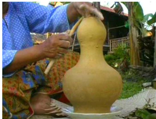
Gambar 11. Bahagian kepala labu tanah terbentuk dan labu dilicin-licinkan dengan menggunakan sudip kayu.
