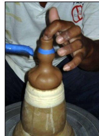
Gambar 22. Engobe disapu pada permukaan tembikar labu
