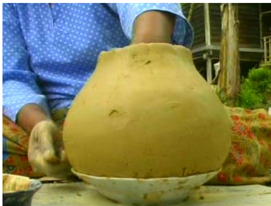
Gambar 10. Dinding labu dicembungkan untuk membuat bahagian badan tembikar.
