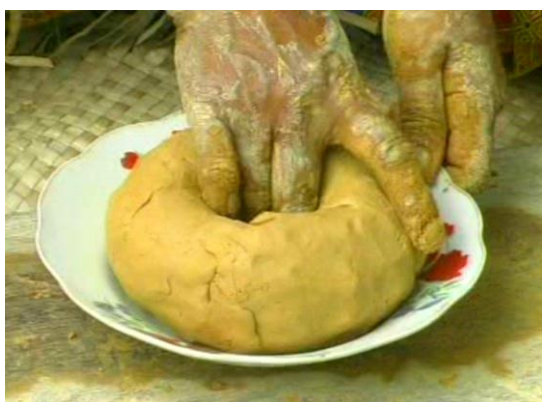
Gambar 8. Lingkaran tanah liat diletakkan di dalam pinggan ayan untuk proses picit-cubit.
