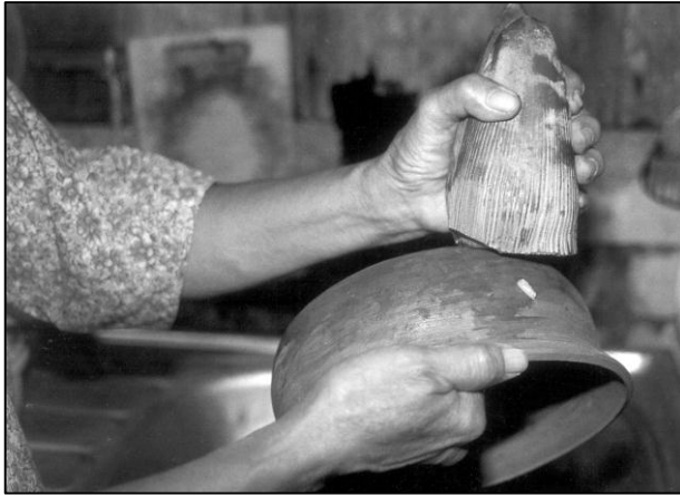
Gambar 31. Melumur getah jantung pisang dibahagian tapak tembikar mambong.
