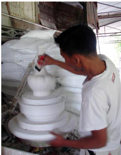
Gambar 14. Model labu tanah masih di atas mesin jolly jigger .
