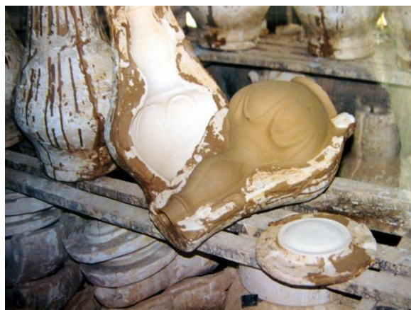
Gambar 17. Jasad labu tanah yang telah separuh kering dalam acuan.
