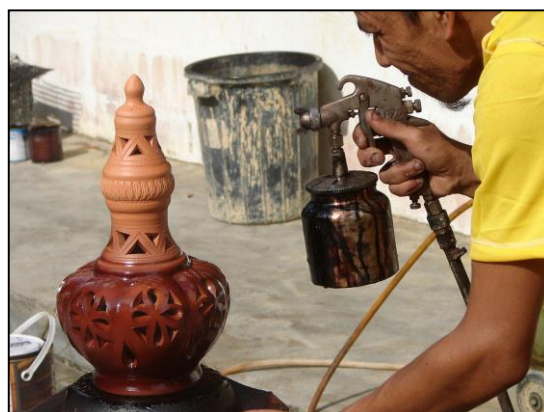
Gambar 25. Spray gun digunakan dalam teknik semburan.
