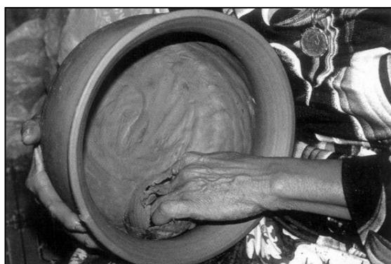
Gambar 12. Meratakan bahagian dalam Mambong menggunakan besi kokot.
