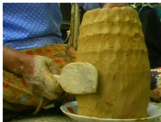
Gambar 9. Dinding tembikar dipadatkan dengan cara menepuk-nepuknya dengan kayu penepik.
